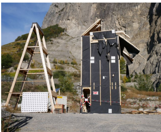
Abb. 17: Der Versagensmechanismus beim Zerstörungsversuch mit einer einzelnen, leicht schräg eingeleiteten Kraft am oberen Ende des vierten Geschosses (links); Das entsprechende Kraft-Verformungs-Diagramm (rechts)
