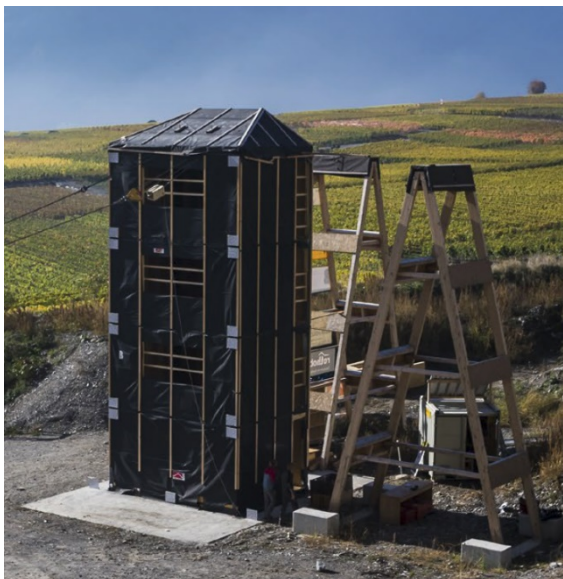
Abb. 16: Testgebäude bereit für den Zerstörungsversuch; die zur Kräfteinleitung verwendeten Stahlseile sind links des Gebäudes zu sehen
