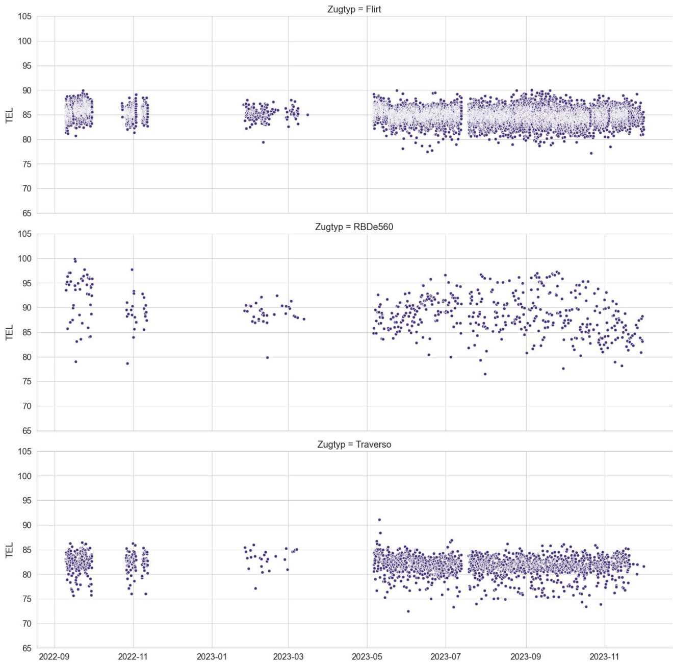
Abbildung A.35.: Verteilung der TEL -Werte über die Zeit für MQ1.1 und die Zugtypen RDe560, Flirt, Traverso.
