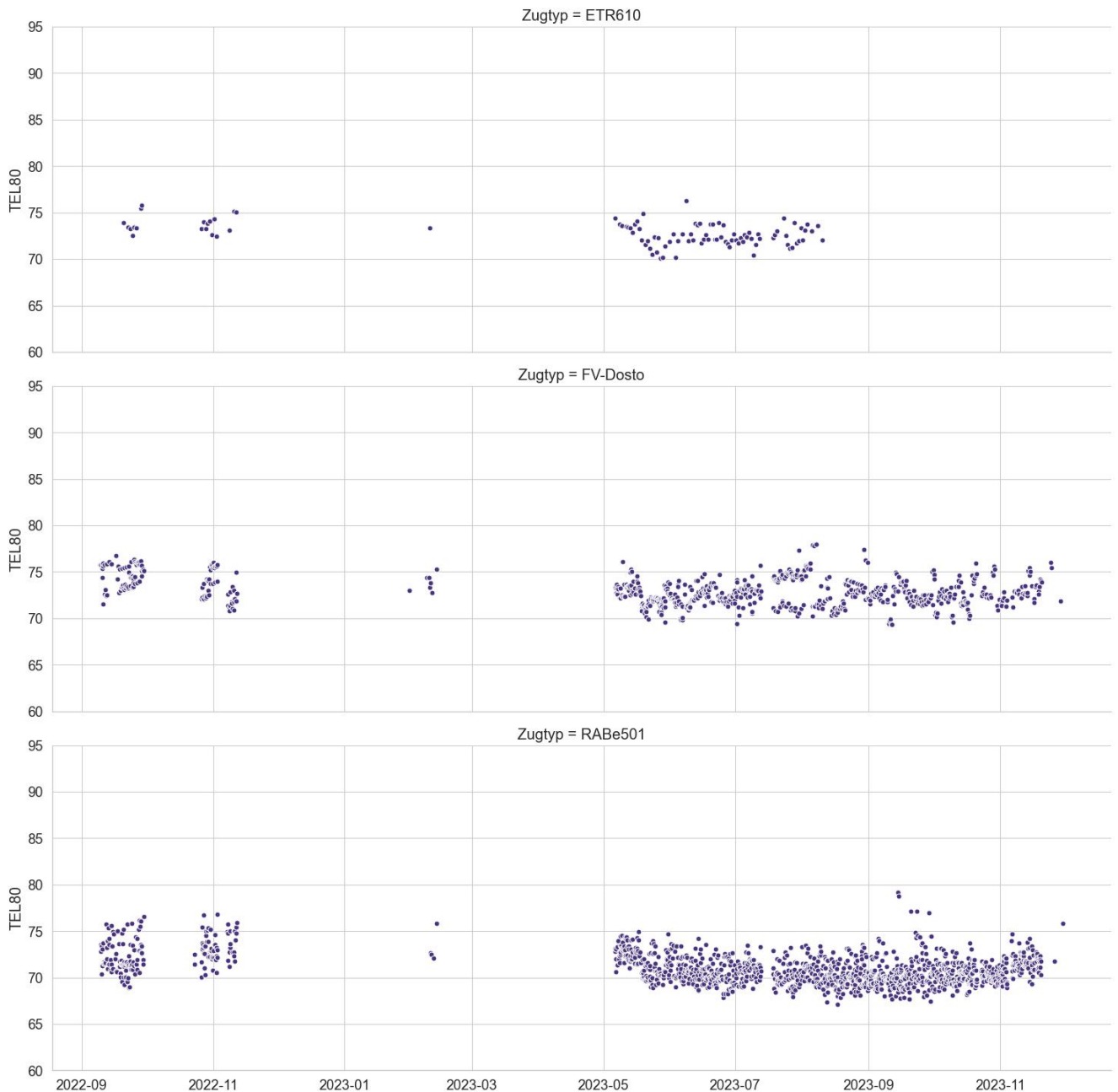
Abbildung 2.7.: Verteilung der TEL80 -Werte über die Zeit für MQ1.1 und die Zugtypen ETR610, RABe501, FV-Dosto.
