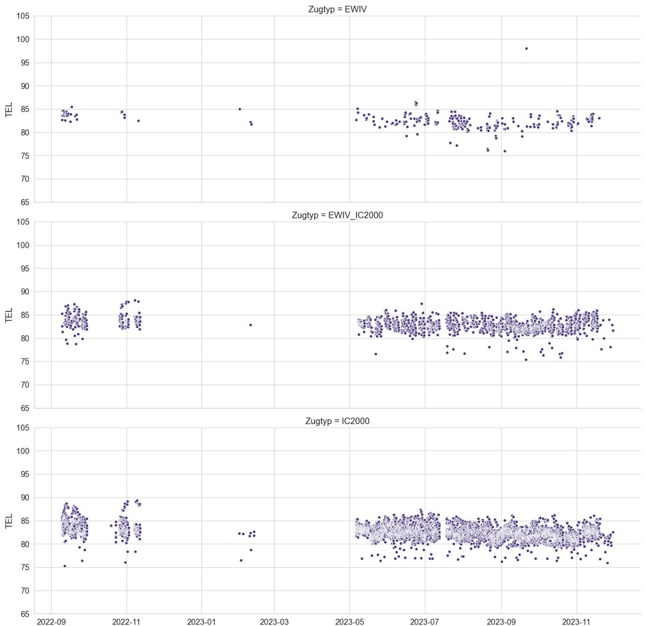
Abbildung A.34.: Verteilung der TEL -Werte über die Zeit für MQ1.1 und die Zugtypen EWIV, EWIV_IC2000 und IC2000.
