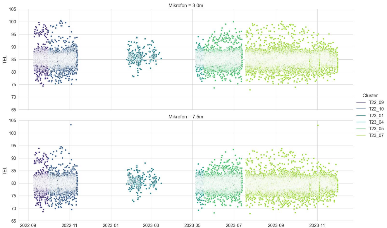
Abbildung A.15.: Verteilung der TEL-Werte über die Zeit für MQ1.3 inkl. unvollständige Messungen.
