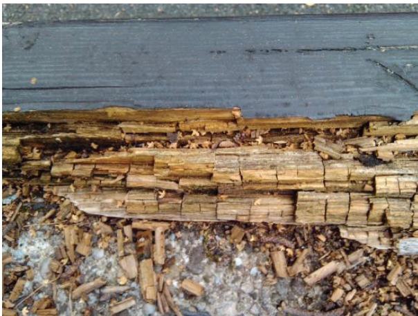
Abb. 2: Braunfäule mit typischer Würfelstruktur an einer Parkbank
