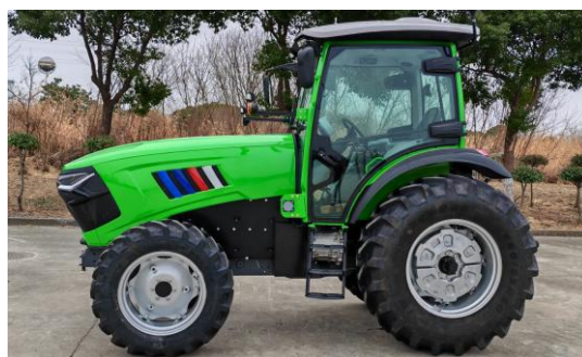
Bild 5: Batterieelektrischer Traktor XEEVO E904i mit 66/90 kW Dauer-/Peakleistung [21].
