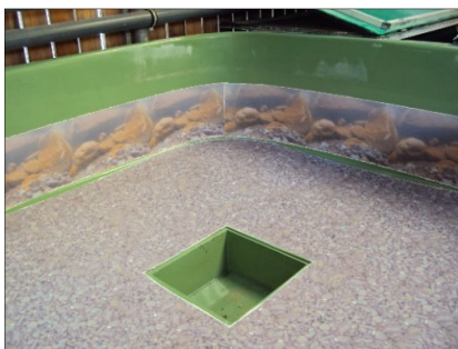
Abbildung 1: Noch leeres Becken mit eingeklebter Enrichment-Folie. Es werden unterschiedliche Motive für Boden und Wand benutzt, um ein natürliches Flussbett zu simulieren.
