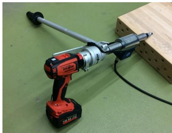
Abbildung 6: Akku-Schrauber mit Drehmomentaufsatz und Drehmomentsensor
