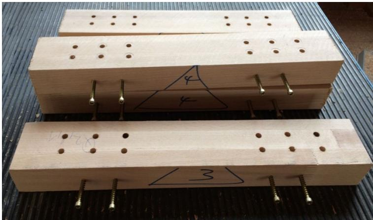
Abb. 17: Verstärkte Stabdübelverbindung
