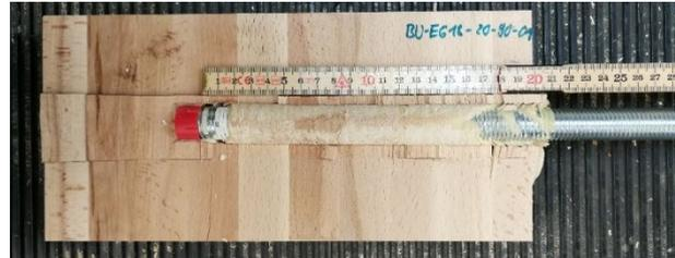
Abb. 28: Querszugversagen im Holz und Versagen des Verbundes Holz-Klebstoff, Serie 18
