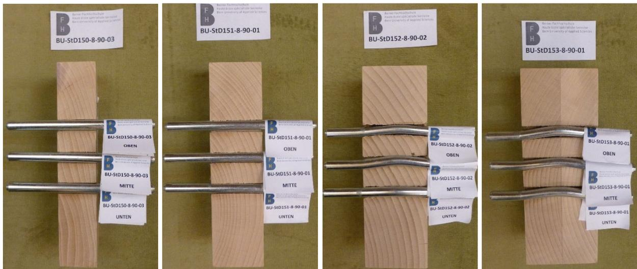
Abb. 110: Exemplarische Darlegung eines aufgesägten Prüfkörpers je Prüferserie im Biegeversuch, Serie 150-153 (v. l. n. r.), keine respektive geringe Ansätze zur Ausbildung von Fließgelenken
