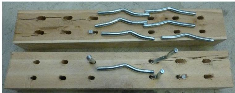
Abb. 45: Versagensarten BU\_StD26\_8\_0\_02: Ausbildung zweier Fliessgelenke, Aufspalten des Holzkörpers entlang der Faser, Abscheren des Verbindungsmittels
