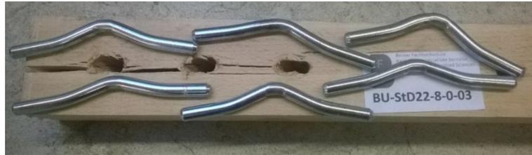
Abb. 39: Versagensarten BU\_StD22\_8\_0\_03: Ausbildung zweier Fliessgelenke, Aufspalten des Holzkörpers entlang der Faser
