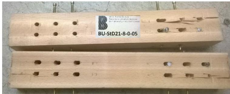
Abb. 36: Versagensarten BU\_StD21\_8\_0\_05: Ausbildung zweier Fließgelenke, Aufspalten des Holzkörpers und Abscheren des Verbindungsmittels, Ausbrechen des Holzes zwischen den Verbindungsmitteln auf Seiten des Stahlblechs
