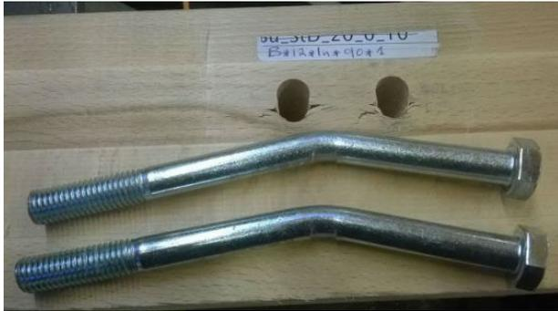
Abb. 90: Verbindung mit Passbolzen und eingeschlitzten Stahlblech, Ausbildung von einem Fließgelenk
