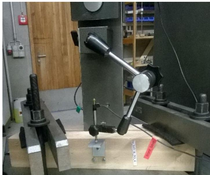
Abb. 21: Prüfaufbau von Stabdübelversuch senkrecht zur Faser
