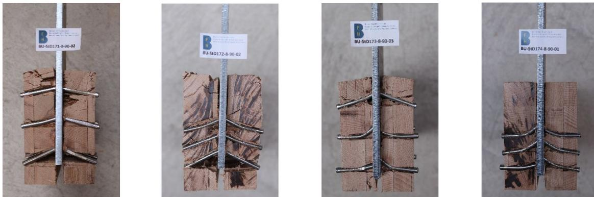
Abb. 122: Versagensfälle innerhalb der Hauptversuchsserien senkrecht zur Faser der Prüfserien BU-StD171-174 (von links nach rechts)
