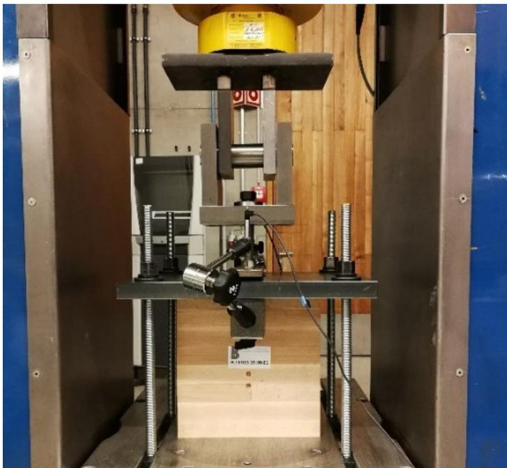
Abb. 25: Zug-Druck-Versuchsvorrichtung
