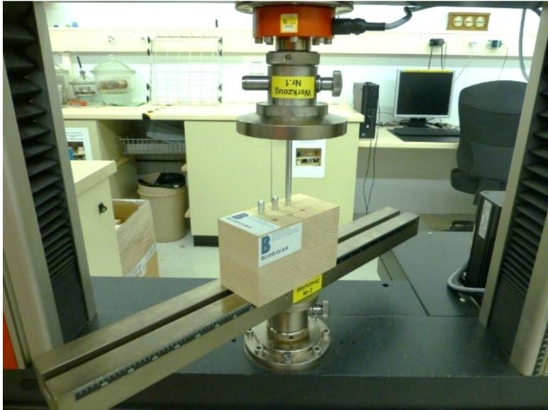
Abb. 11: Einbringen der Stabdübel mit Prüfmaschine, Prüferie 2
