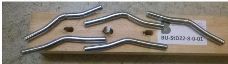
Abb. 40: Versagensarten BU\_StD22\_8\_0\_01: Ausbildung zweier Fliessgelenke, Abscheren des Verbindungsmittels
