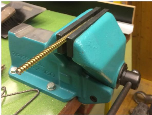
Abbildung 7: Einspannung einer Schraube zur Ermittlung des Bruchdrehmoments
