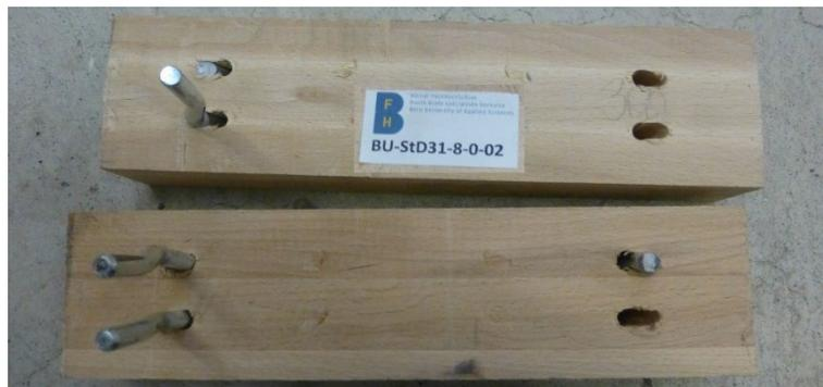
Abb. 54: BU\_StD31\_8\_0\_02: Ausbildung zweier Flie遝gelenke, Abscheren des Verbindungsmittels
