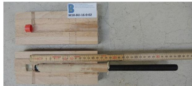
Abb. 19: Ausziehen bei Bohrdurchmesser  $d+4$  mm in Serie M10
