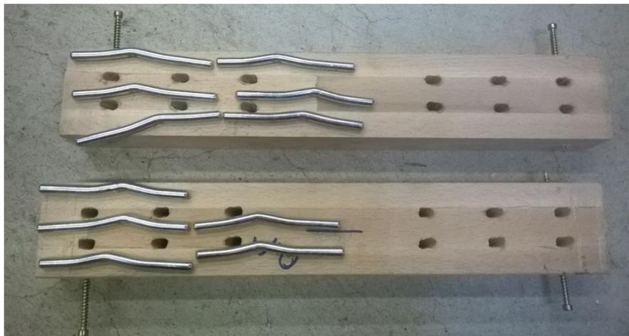
Abb. 49: BU\_StD30\_8\_0\_03: Geringe Spaltrisse bei Verbindungen mit verstärkten Rändern ( $a_3$ )
