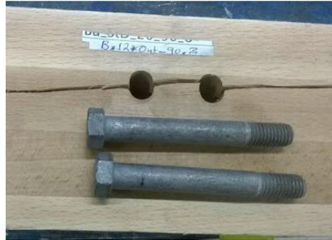
Abb. 91: Verbindung mit Passbolzen und aussenliegenden Stahlblechen, Querzugversagen
