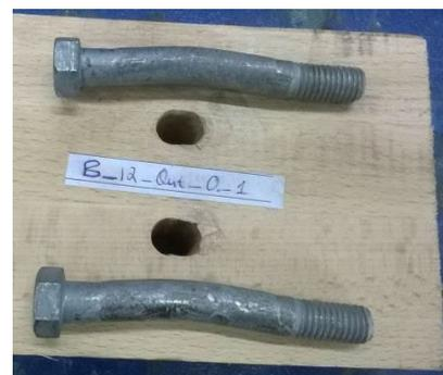
Abb. 85: Verbindung mit Passbolzen und aussenliegenden Stahlblechen, Ausbildung von einem Fließgelenk
