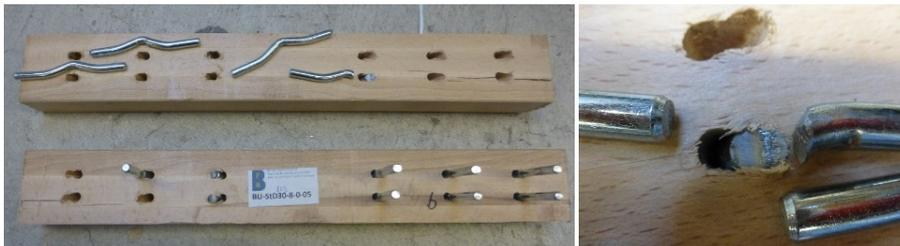
Abb. 34: Versagensarten BU\_StD18\_8\_0\_05: Ausbildung zweier Fließgelenke, Aufspalten des Holzkörpers und Abscheren des Verbindungsmittels
