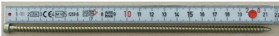
Abbildung 58: Schrauben Würth Assy 6 mm
