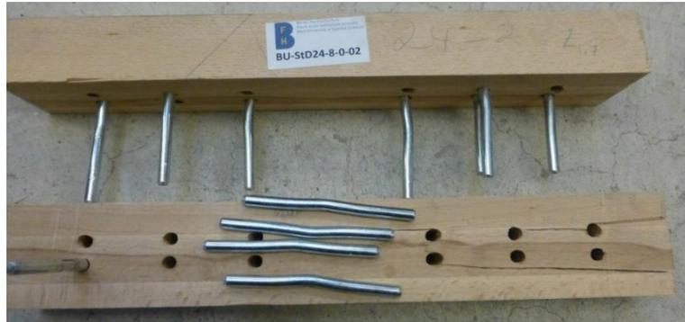
Abb. 44: Versagensarten BU\_StD24\_8\_0\_02: Ausbildung zweier Fliessgelenke, Aufspalten des Holzkörpers entlang der Faser
