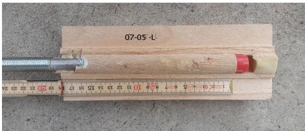
Abb. 32: Schubversagen des Holzes im Bereich der Klebefuge, Serie 7
