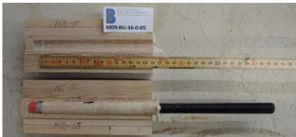
Abb. 18: Ausziehen bei Bohrdurchmesser  $d+2$  mm in Serie M09
