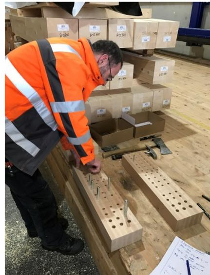
Abb. 9: Einbringen der Stabdübel
