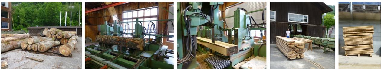
Abb. 4: Aufbereitung des Stammholzes mit Einschnitt und Lufttrocknung an der Berner Fachhochschule (v.l.n.r.)
