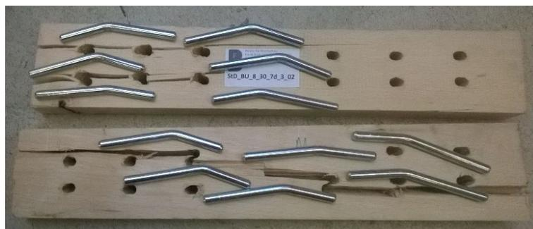
Abb. 60: BU\_StD47\_8\_0\_02 (t = 30 mm): Aufspalten des Holzes, Ausbrechen des Holzes zwischen den Verbindungsmitteln, Ausbildung eines Fließgelenks
