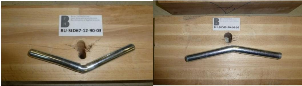
Abb. 78: Versagensbild BU\_StD67\_12\_90\_03: Versagen auf Ausbildung eines Fließgelenks. Auftretende Spaltrisse entlang der Faser
