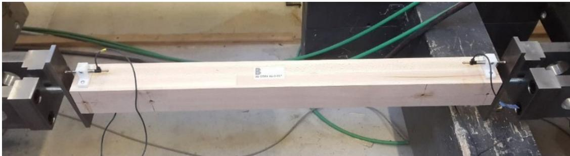
Abb. 24: Eingespannter Prüfkörper als Zug-Zug-Versuch
