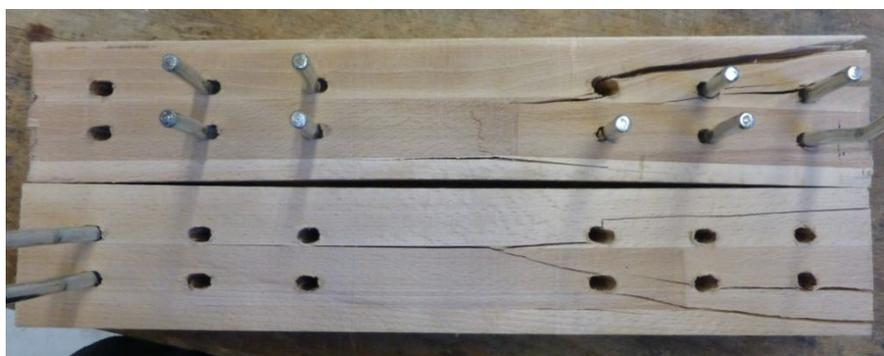
Abb. 50: BU\_StD29\_8\_0\_03: Stark ausgeprägte Spaltrisse bei unverstärkten Verbindungen mit reduzierten Randabständen ( $a_3 = 5d$ )
