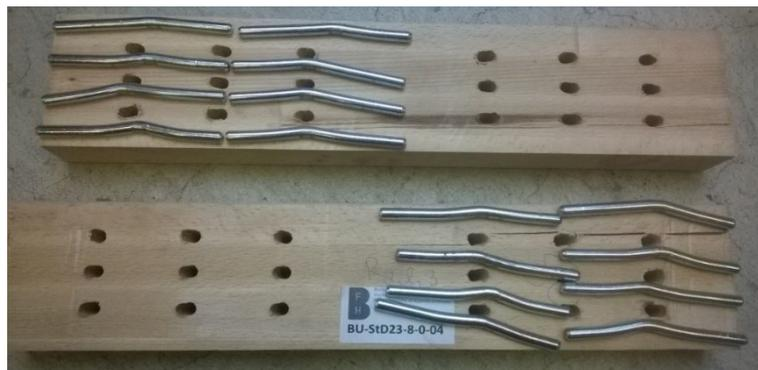
Abb. 41: Versagensarten BU\_StD23\_8\_0\_04: Ausbildung zweier Fliessgelenke, Aufspalten des Holzkörpers entlang der Faser
