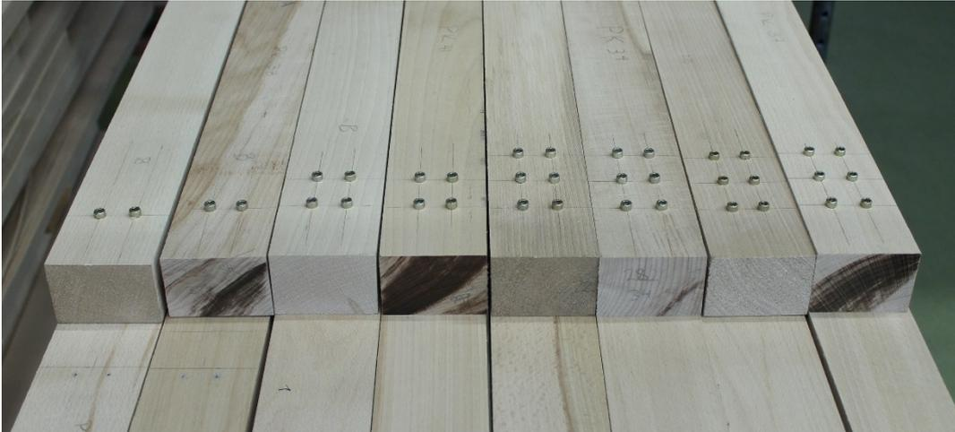
Abbildung 115: Prüfkörperserien mit verschiedener Anzahl Verbindungsmittel
