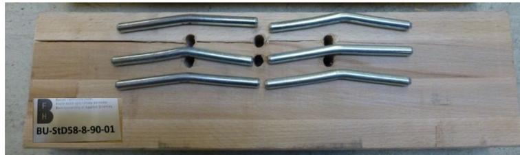
Abb. 71: Versagensbild BU\_StD58\_8\_90\_01: Aufspalten des Holzkörpers in der Verbindungsreihe mit grösstem Abstand vom beanspruchten Rand. Ausbildung eines Fliessgelenkes
