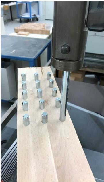
Abb. 14: Einbringen der Stabdübel mit Prüfmaschine
