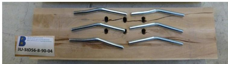
Abb. 68: Versagensbild BU\_StD56\_8\_90\_04: Aufspalten in der Reihe mit grösstem Abstand vom beanspruchten Rand. Ausbildung eines, teilweise zweier Fließgelenke
