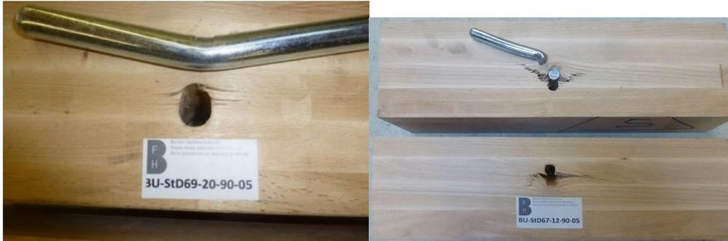
Abb. 79: Versagensbild BU\_StD69\_20\_90\_05: Versagen auf Ausbildung eines Fließgelenks
