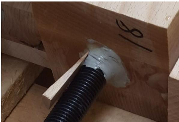
Abb. 8: Einklebte Gewindestange abgedichtet mit Butylkautschukband und zentriert mit Holzkeilen
