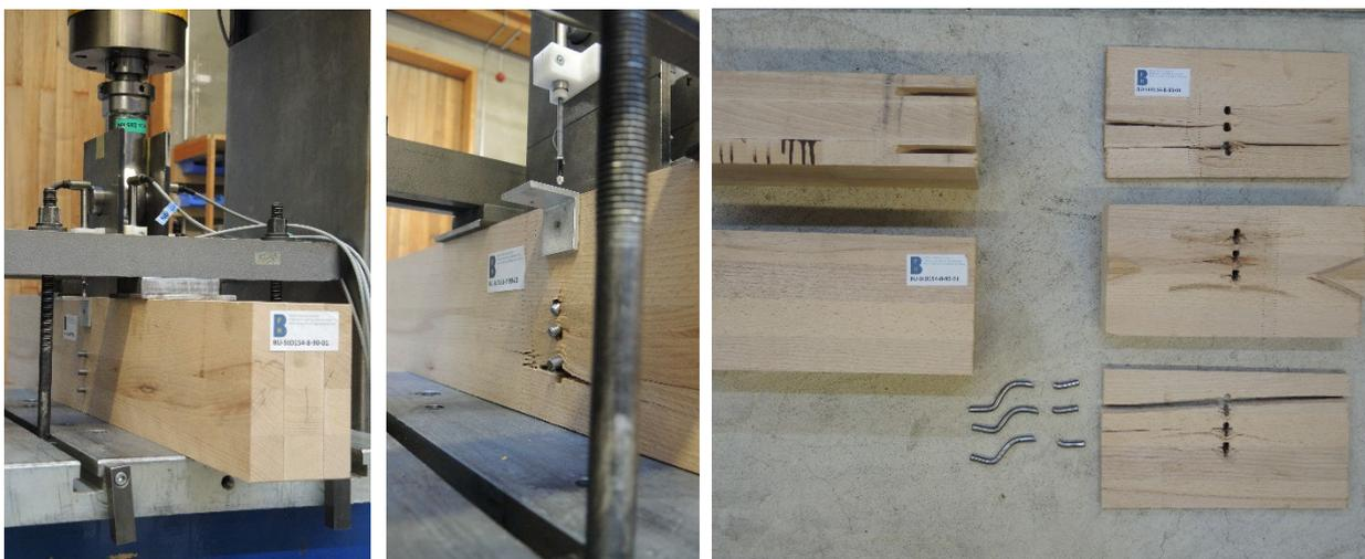
Abb. 114: Versuchsaufbau zum Einfluss der Seitenholzdicke bei Verbindungen mit 2 innenliegenden Stahlblechen (links), Querzugversagen in oberster Verbindungsmittelreihe (Mitte), verformte Stabdübel am aufgeschnittenen Prüfkörper (rechts)
