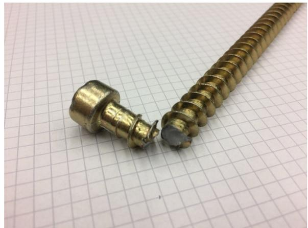
Abbildung 8: Schraube des Herstellers Würth nach der Versuchsdurchführung
