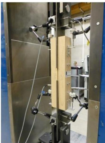
Abb. 20: Prüfaufbau von Stabdübelversuch parallel zur Faser in 250 kN Maschine
