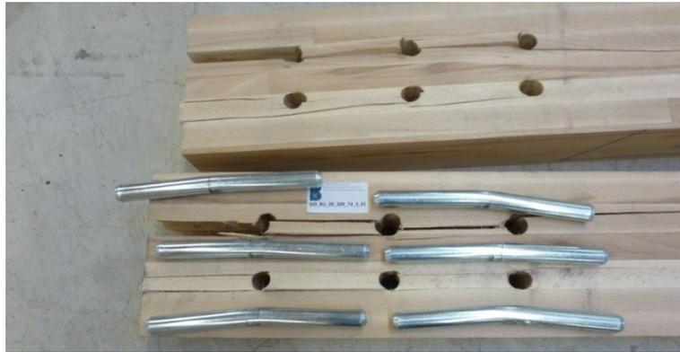
Abb. 65: Versagensbild BU\_StD53\_20\_0: Aufspalten und Abscheren des Holzkörpers.
