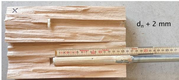
Abb. 16: Schubversagen des Holzes bei kleinem Bohrdurchmesser Serie EG01\_neu
