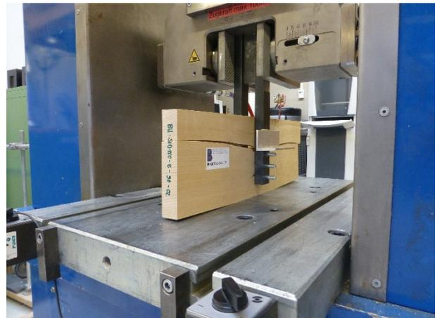
Abb. 109: Versuchsaufbau für Prüfserien zur Mittelholzdicke, senkrecht zur Faser beansprucht, Biegeversuch (links) und Druckversuch (rechts)
