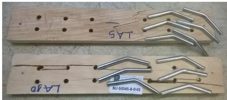
Abb. 59: BU\_StD45\_8\_0\_01 (t = 20 mm): Aufspalten des Holzes, Ausbrechen des Holzes zwischen den Verbindungsmitteln, Zugversagen des Holzes, Ausbildung eines Fließgelenks
