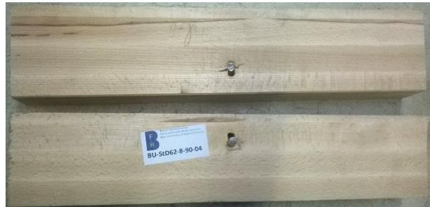
Abb. 75: Versagensbild BU\_StD61\_8\_90\_04: Versagen nach Abscheren des Verbindungsmittels
