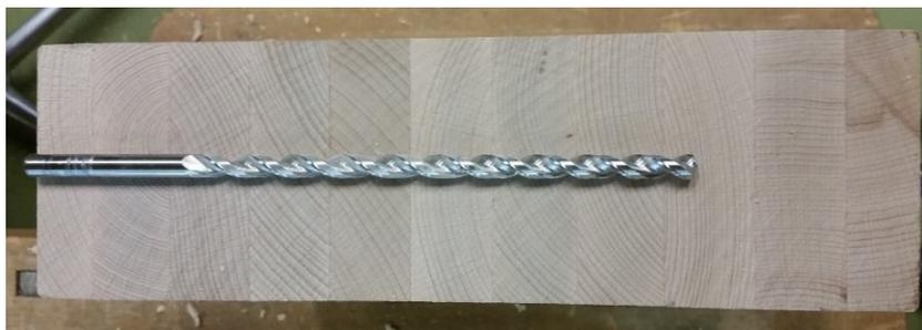
Abbildung 34: Maximales Eindringen des Bohrers zum Vorbohren der Schraubenlöcher
