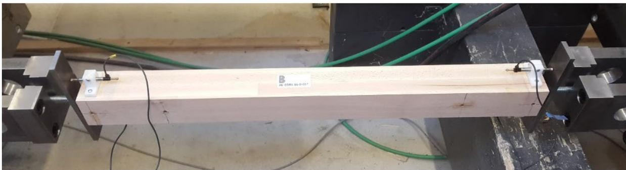
Abb. 10: Eingespannter Prüfkörper als Zug-Zug-Versuch
