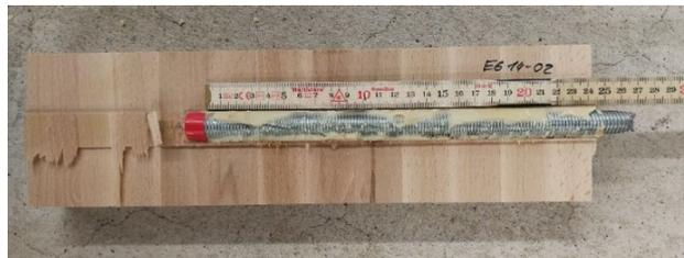
Abb. 35: Ausbilden von Druckstreben im unteren Bereich, Kohäsionsversagen des Klebstoffes, Serie 10
