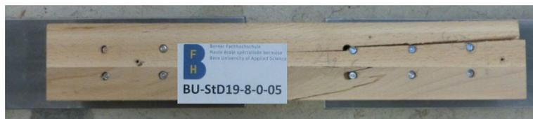
Abb. 35: Versagensarten BU\_StD19\_8\_0\_05: Aufspalten des Holzkörpers
