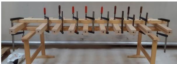
Abb. 5: Liegende Verklebung der Prüfkörper
