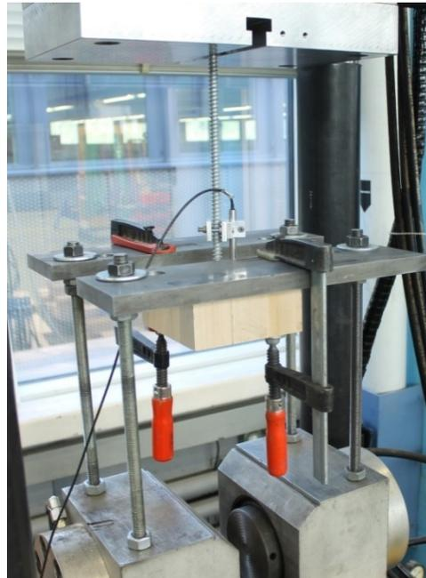
Abbildung 9: Schematische Darstellung und Abbildung des Prüfaufbaus für die Ausziehprüfungen.
