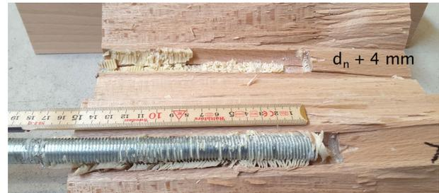
Abb. 17: Klebefugenversagen bei grossem Bohrdurchmesser Serie EG02\_neu
