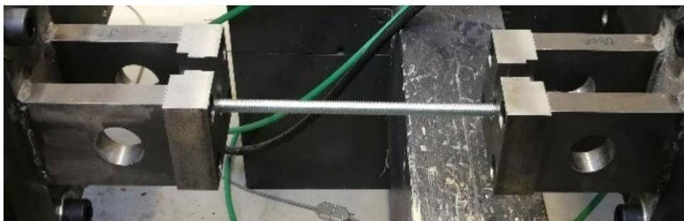
Abb. 2: Prüfordnung für den Stahlzugversuch der Gewindestangen
