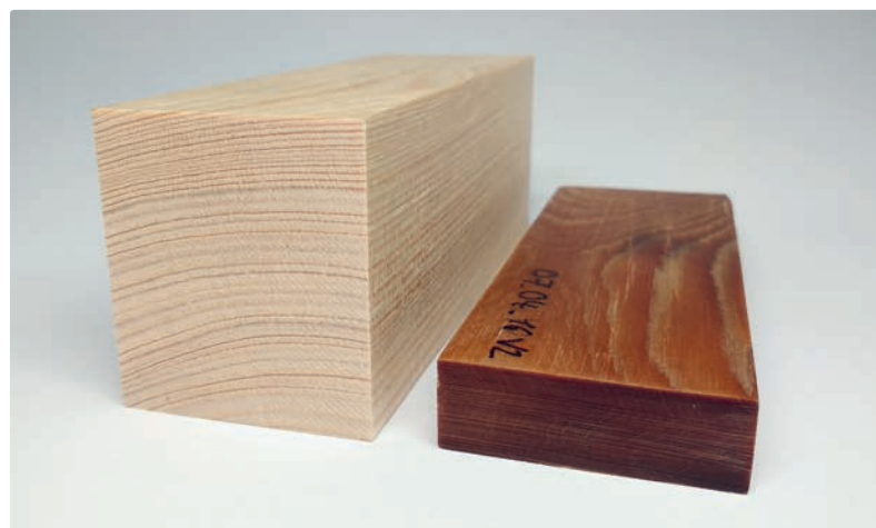
Figure: gauche: sapin blanc, densité de 450 kg/m 3 . Droite: sapin blanc densifié à 67%, densité de 1350 kg/m 3 .
