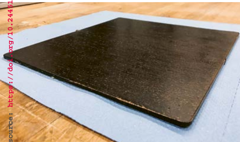
Prototyp eines schwer entflammaren Biocomposites aus Gerbstoffharzen und Flachsfasern
