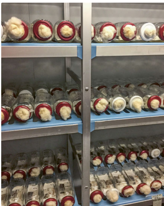
Séries d'essais de résistance biologique chez le partenaire CIRAD (France)
