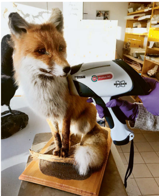
Schnellerkennung einer Pestizidbelastung an einem Exponat durch Bestimmen der Atomzusammensetzung der Objekt-oberfläche mittels Röntgenfluoreszenz
