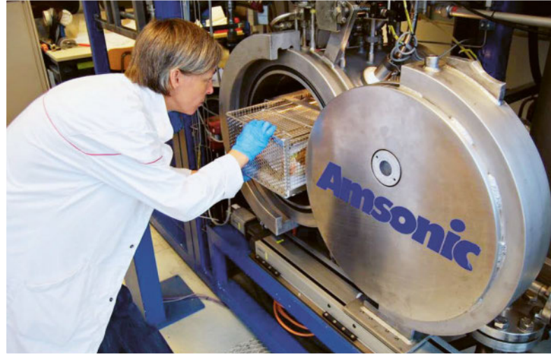
Bestückung der Pilotanlage der Amsonic AG mit Kulturgutobjekten zur Reinigung mit flüssigem CO 2
