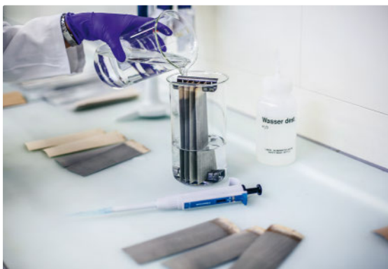
Auch gerbstoffarme und eher helle Hölzer (z.B. Buche) können in mehrstufigen Verfahren dunkel gefärbt werden.
