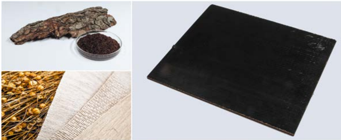
Abbildung 3: Tannin-Flachsfaser-Verbundwerkstoffe (rechts) werden vollständig aus nachwachsenden und nachhaltigen Rohstoffen hergestellt: Rindentanninen und Flachsfasern.
