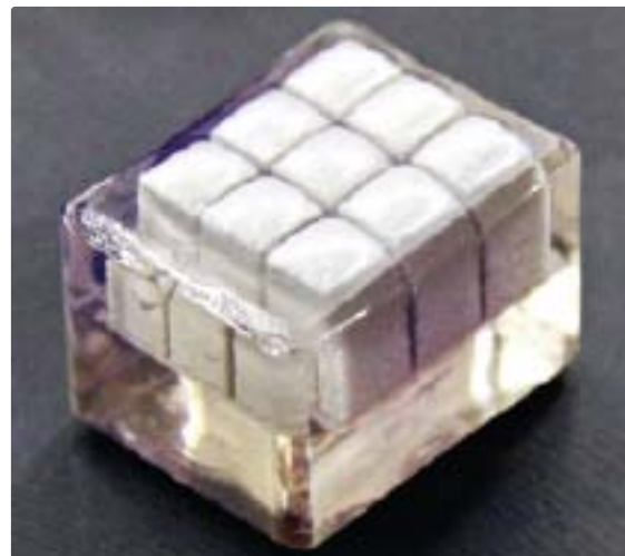
Laserinduzierte lokale Kristallisation in einer Glaskeramik
