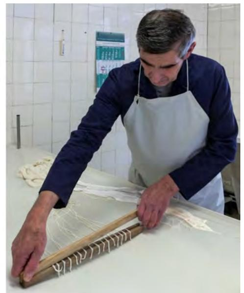
Abbildung 3: Einziehen der Saiten (aus Geipel: *Saiten- und Catgutherstellung*, S. 14)
