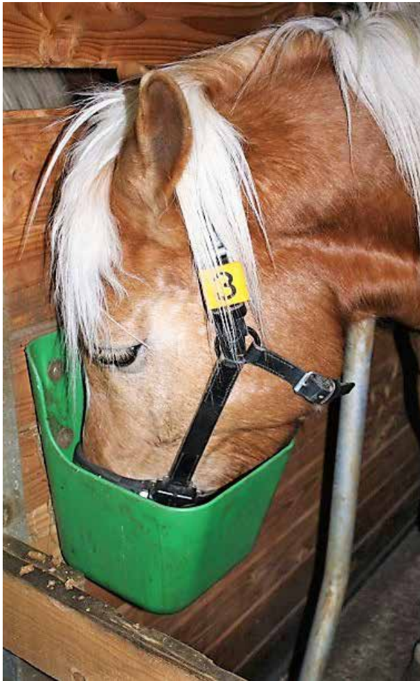
Versuchspferd mit dem Equiwatch®-Halfter zur Messung von Futteraufnahmezeit und Kaufrequenz.
