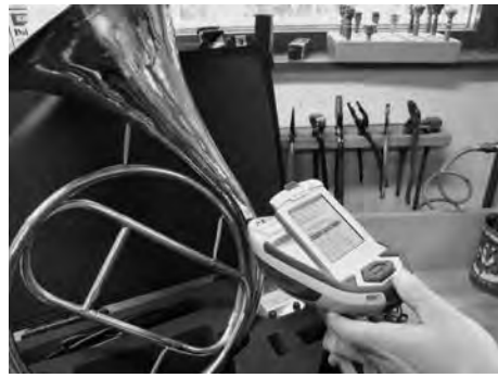
ABBILDUNG 1 Das mobile NITON-Gerät im Einsatz am Horn Nr. 2
