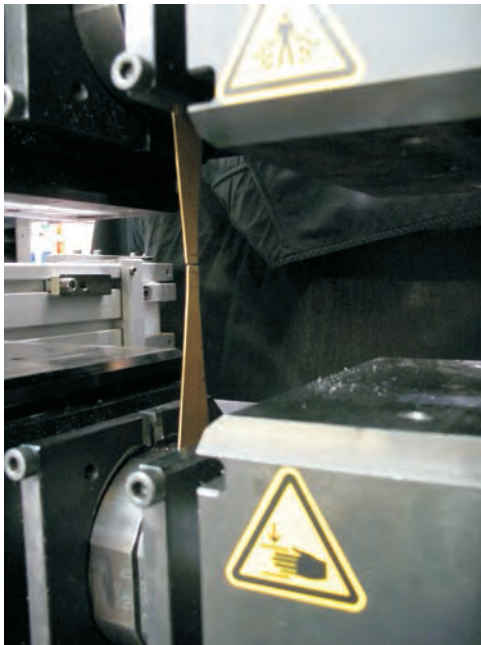
ABBILDUNG 14 Links gerissener Keil nach Zugversuch, oben Mikrographie: Gefüge des mit Ammoniumpersulfat makrogeätzten Keils mit leicht längs gestreckten Körnern
