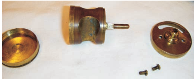
ABBILDUNG 7 Drehventil mit Vierkantschliff am Ventilhals
