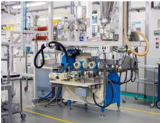
Abb. 4 | Doppelwellenextruder zur Proteintexturierung (links) sowie Produktbeispiele von pflanzlichbasierten Trocken- und Nasstexturaten (rechts). (Fotos: HAFL)
