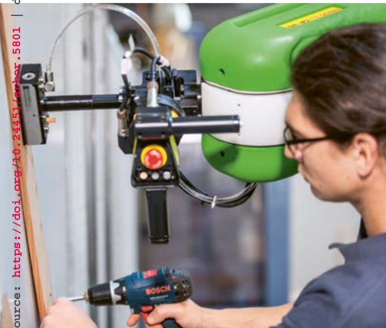
«Timo», der kollaborative Roboter interagiert mit dem Menschen ohne Schutzeinrichtung.
