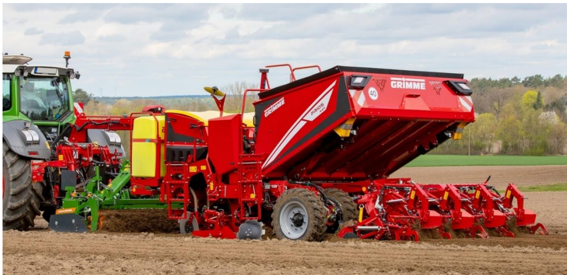
Bild 3: Gezogene 4-reihige Legemaschine mit verlängerter Schwanenhalsdeichsel für die Bodenbearbeitung und neuartigen Werkzeugen für die Dammbildung [4].
