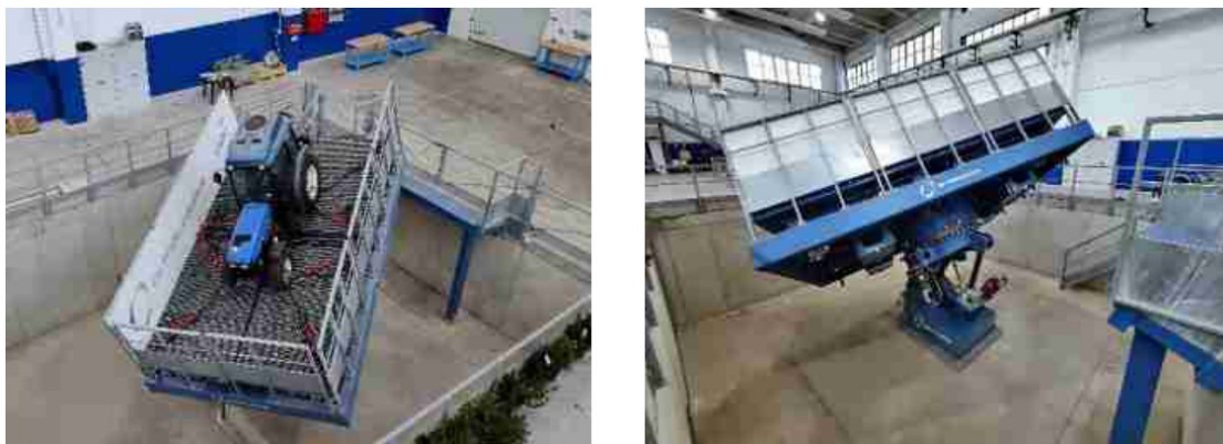
Bild 3: Prüfstand zur Überprüfung der Traktorstabilität [18].
