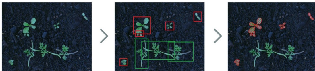
Bild 4: Ablauf von Bildaufnahme (links), Pflanzen- (grün) und Beikrautererkennung (rot) und Laserzielbestimmung (rot schraffiert) beim K.U.L.T.aiLaser [12].
