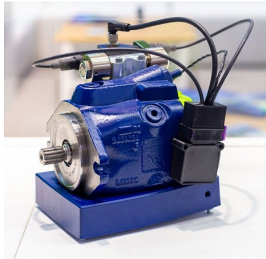
Bild 5: Digitalhydraulisches Regelsystem für Axialkolbenpumpen [6].
