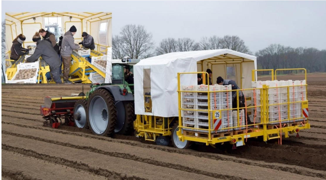
Bild 1: Speziell für vorgekeimte Kartoffeln entwickelte 4-reihige Legemaschine [3].
