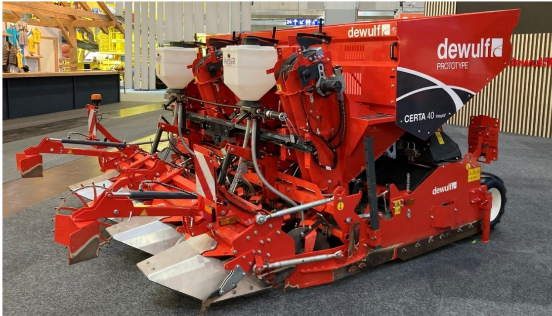
Bild 2: Getragene 4-reihige Legemaschine mit integrierter Bodenbearbeitung und Vorratsbunker für Pflanzgut auf Wiegestäben [Eigene Darstellung].
