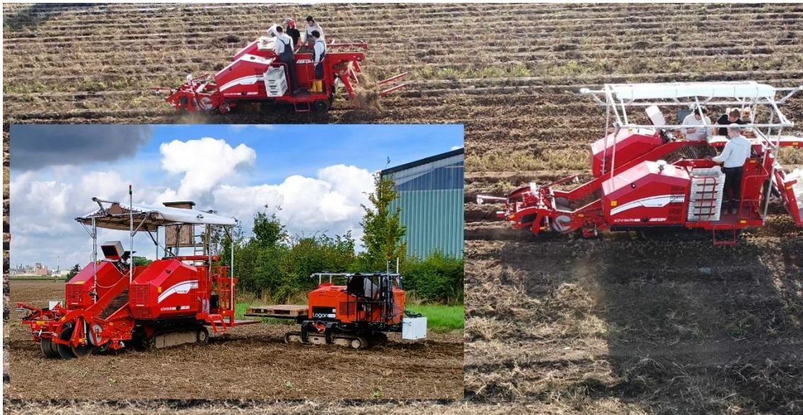
Bild 8: Studie zur Schwarmrobotik für die Ernte und den Abtransport von empfindlichen Knollen- und Wurzelfrüchten [Eigene Darstellung].
