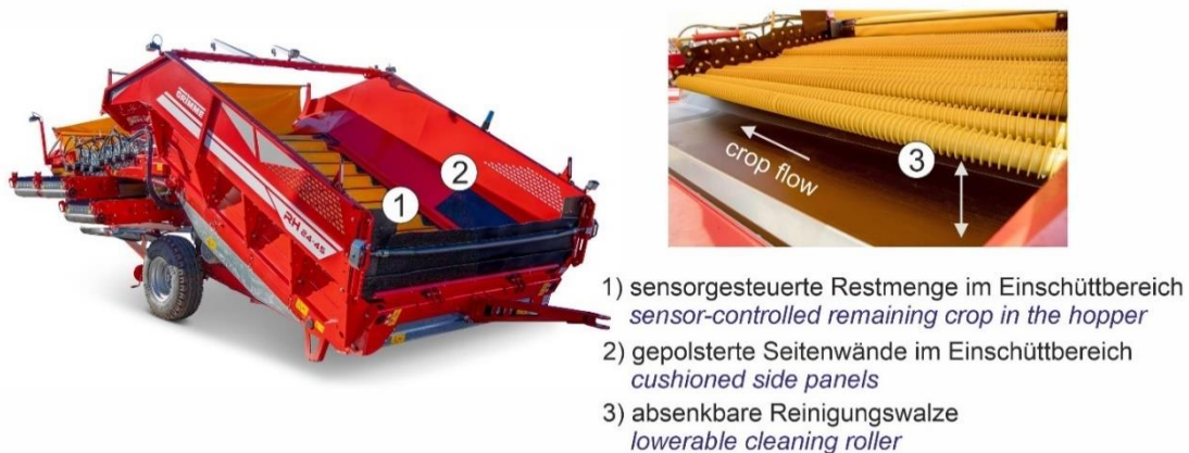
Bild 9: Ausgewählte Detaillösungen bei Schüttbunkern zur Verbesserung der Produktqualität während der Einlagerung von Kartoffeln [Eigene Darstellung].
