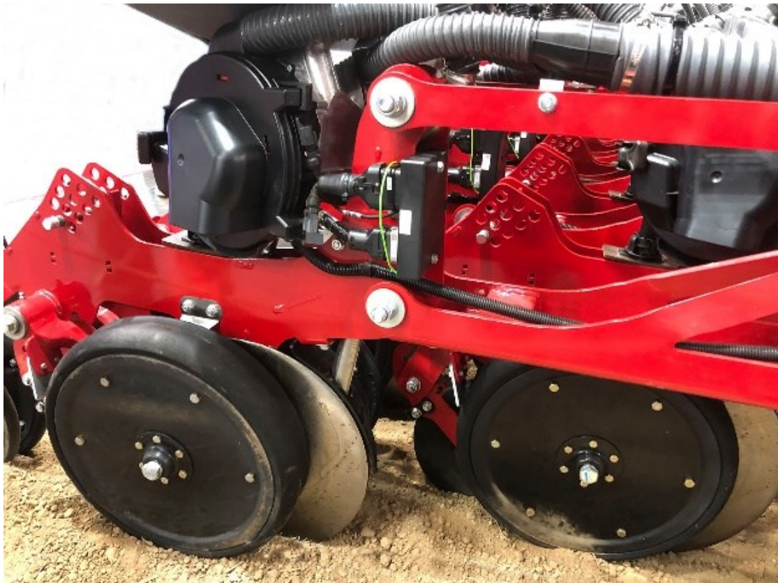
Bild 3: Säeinheit Universaleinzelkornsämaschine von Horsch [Eigene Darstellung]. Figure 3: Seeding unit of the Horsch universal precision planter [own presentation].
