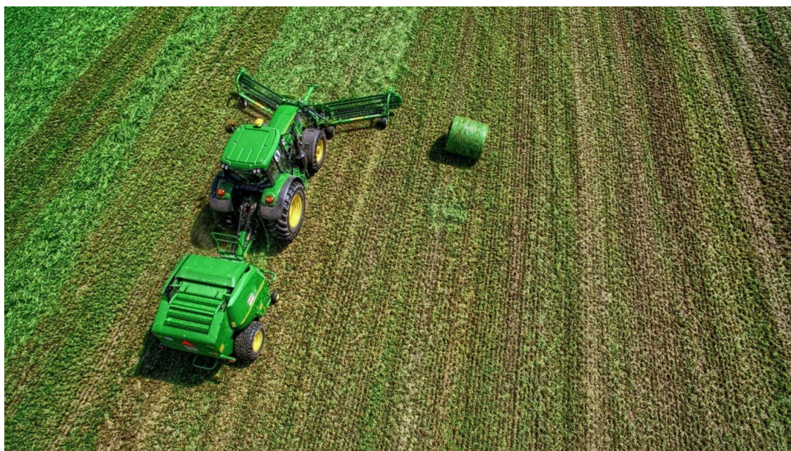
Bild 2: Kammschwader der Baureihe Twist von Samasz im Einsatz vor einer Rundballenpresse [22].
