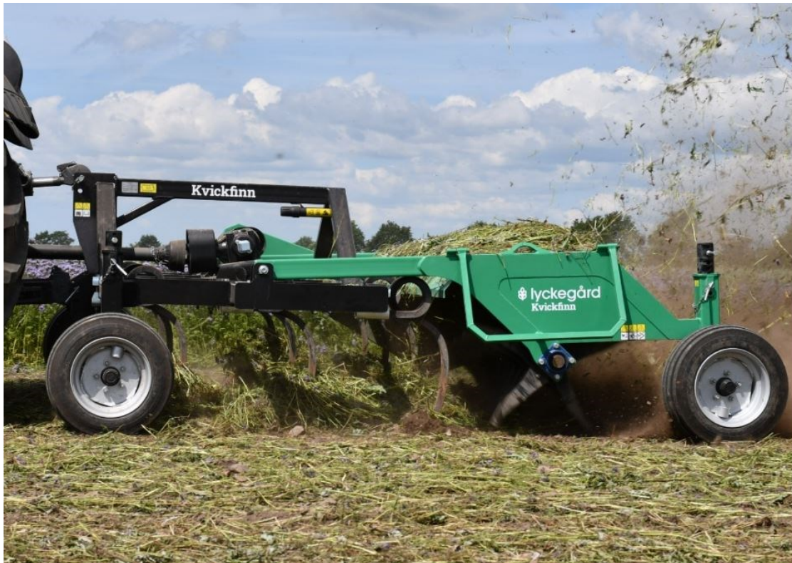
Bild 2: Maschinenkonzept Kwickfinn von Lyckegård mit passiven und aktiven Werkzeugen [14]. Figure 2: Kwickfinn machine concept from Lyckegård with passive and active tools [14].
