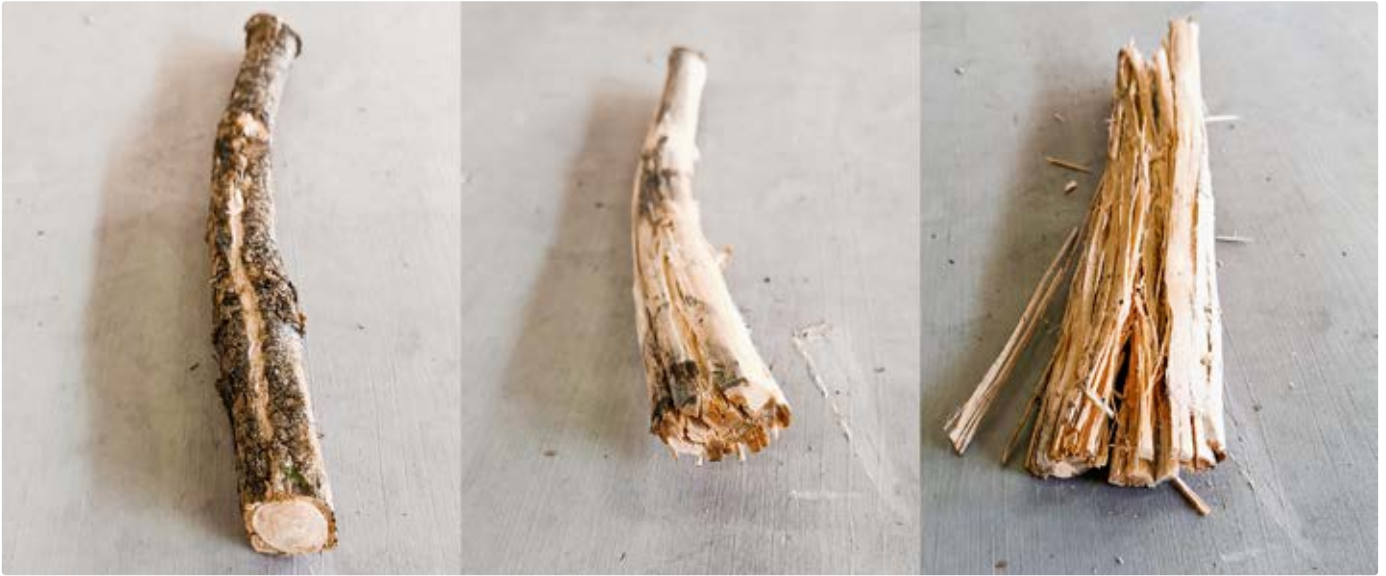
Abbildung 1: Beispielhafte Darstellung der Zerspreisselung eines Astabschnitts.
