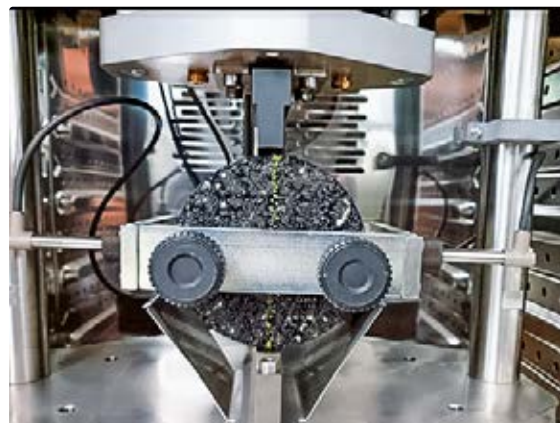
Figure 1 : Essai de rigidité IT-CY, SN EN 12697-26.
