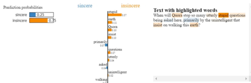
Abbildung 1: Eine Salienzkarte, die unter Verwendung des LIME-Erklärers auf einem Modell erstellt wurde, das trainiert wurde, um auf Quora gestellte Fragen als aufrichtig oder unaufrichtig zu klassifizieren. Blau hervorgehobene Wörter zeigen an, dass die Frage aufrichtig ist, während orange hervorgehobene Wörter das Gegenteil anzeigen. Die undurchsichtige Hervorhebung zeigt die Wörter mit dem grössten Beitrag an (Bildquelle [ https://towardsdatascience.com/what-makes-your-question-insincere-in-quora-26ee7658b010 ]).
