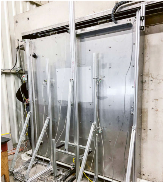
Tunneltür auf dem Prüfstand: das Prüfverfahren wird jedes Mal den konkreten Vorgaben des Bestellers bezüglich des Brand- und Personenschutzes angepasst. (Bild: BFH)
