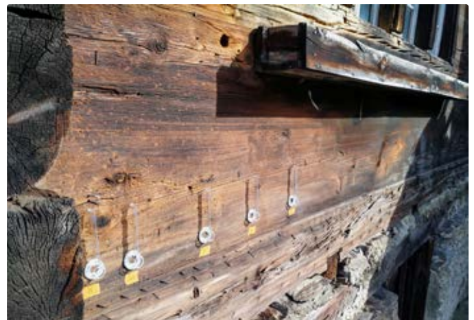
Versuche zur Bestimmung der Feuchtaufnahme von historischen Blockwänden an einem Gebäude in Ausserbinn.
