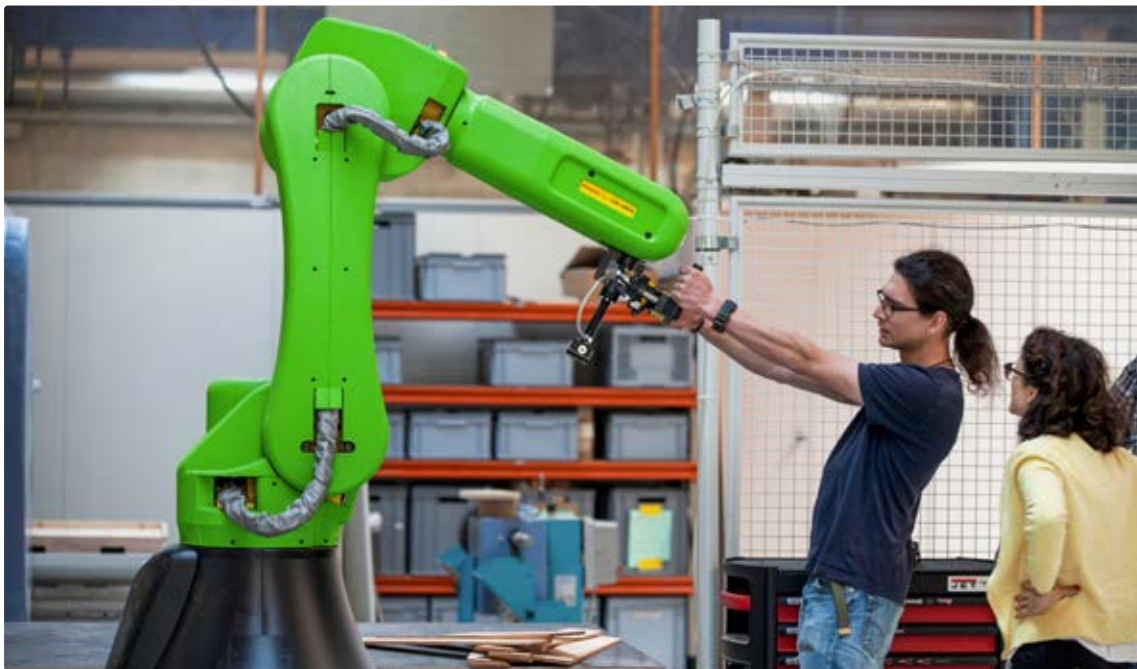
Heute arbeiten kollaborative Roboter, unter Einhaltung aller Sicherheitsstandards, direkt mit den Menschen zusammen.
