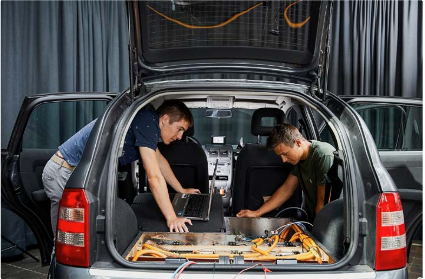
Batterie im Heck: Elektrotechnik und Informationstechnologie im Kofferraum des Audi A2. Die dicken Kabel dienen der Stromversorgung des Motors, während mit dem Laptop jede einzelne Zelle der Batterie überwacht werden kann.
