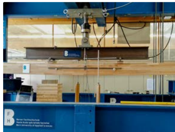
Mit der Innovation des Buchenstabschichtholzes werden Träger mit einer Biegefestigkeit von über 60 Megapascal (MPa) möglich.
