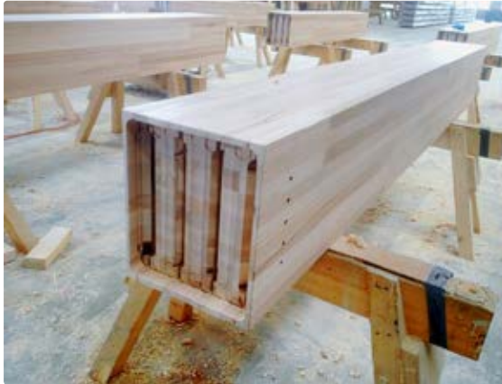
Stabschichtholz: höhere Ausbeute beim Rohmaterial und höhere Festigkeiten
