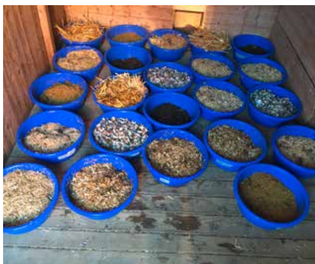
Abb. 1 | Acht Einstreumaterialien mit 400 g in Schalen zur täglichen Durchmischung mit 60 g Kot und 30 ml Harn über 7 Tage zur Messung der Ammoniakemissionen. (Foto: Jan Kocher, HAFL)
