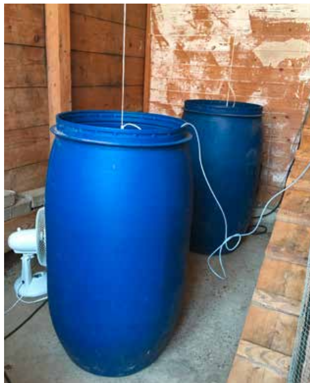
Abb. 3 | Kunststofffässer mit eingehängten Ammoniak Sensoren und Ventilator zur anschliessenden Raumumlüftung. (Foto: Jan Kocher, HAFL)
