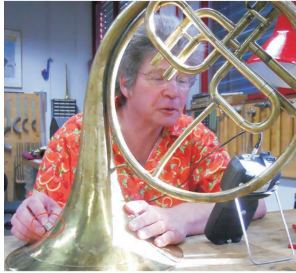
ABBILDUNG 1 Andrea Fornaro misst die Wandstärke an einem Schallstück (Prüfkopf rot umrandet). Das Gerät misst Metalldicken mittels Ultraschall.
