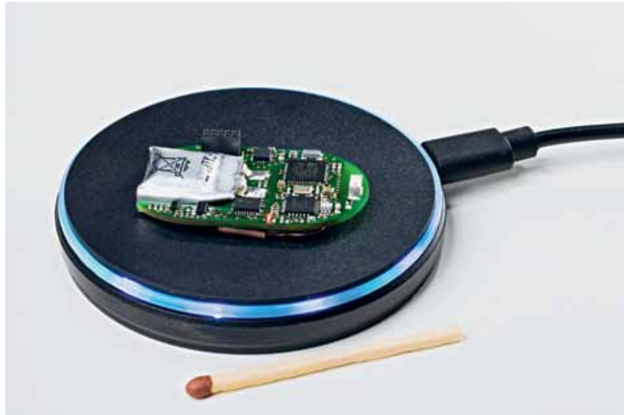
Prototyp des AIDE-MOI-Sturzsensors auf einer drahtlosen, induktiven Ladeschale. Das 25 × 42 mm grosse AIDE-MOI wird anschliessend vollständig in biokompatibles Silikon vergossen, mit einem hautverträglichen Pflaster am Thorax befestigt und kann bei einem Sturz zusammen mit einer Smartphone-App Vertrauenspersonen per SMS und E-Mail alarmieren. Foto: arteplus.ch
