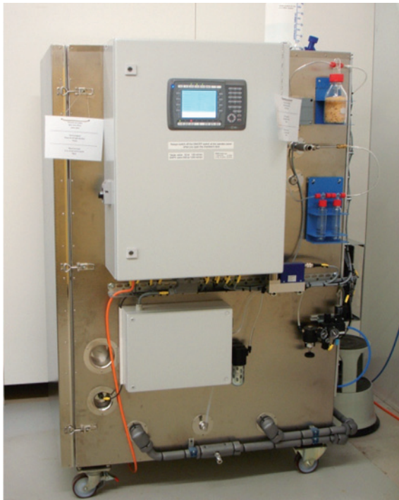
Abbildung 2: Emissionsprüfkammern (rechts: 23 l-Kammern; links: 1 m 3 -Kammer)
