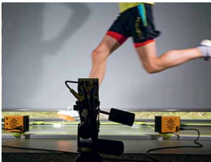
Perspektive der Highspeed-Videokamera; zum Vergleich wurde eine Bodenkontaktzeit pro Lauf gleichzeitig mit PARTwear-Sensoren und Kamerasystem erfasst. Foto: Thomas Oehrli
