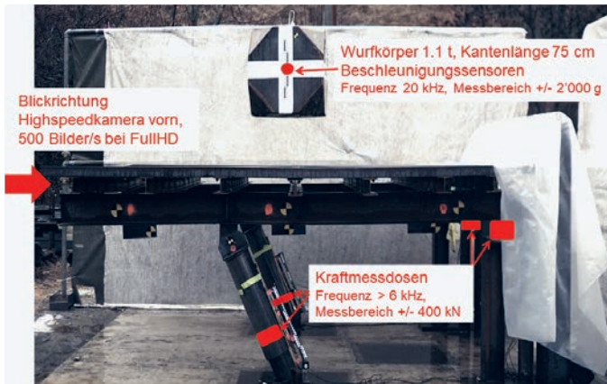
Abb. 2: Seitenansicht Versuchsaufbau und Messtechnik
